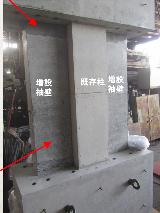
袖壁増設補強 (生コン仕様の試験体)
